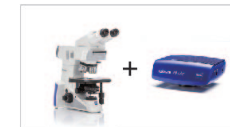
通过与蔡司Axiocam208 color相结合，蔡司Axiolab 5可独立于计算机系统运行。
