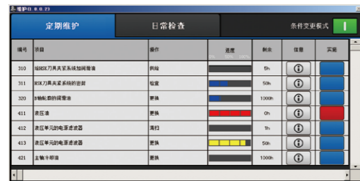
显示日常、定期点检等项目的维护监视器
