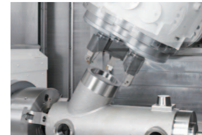
支持倾斜轴的车削加工
